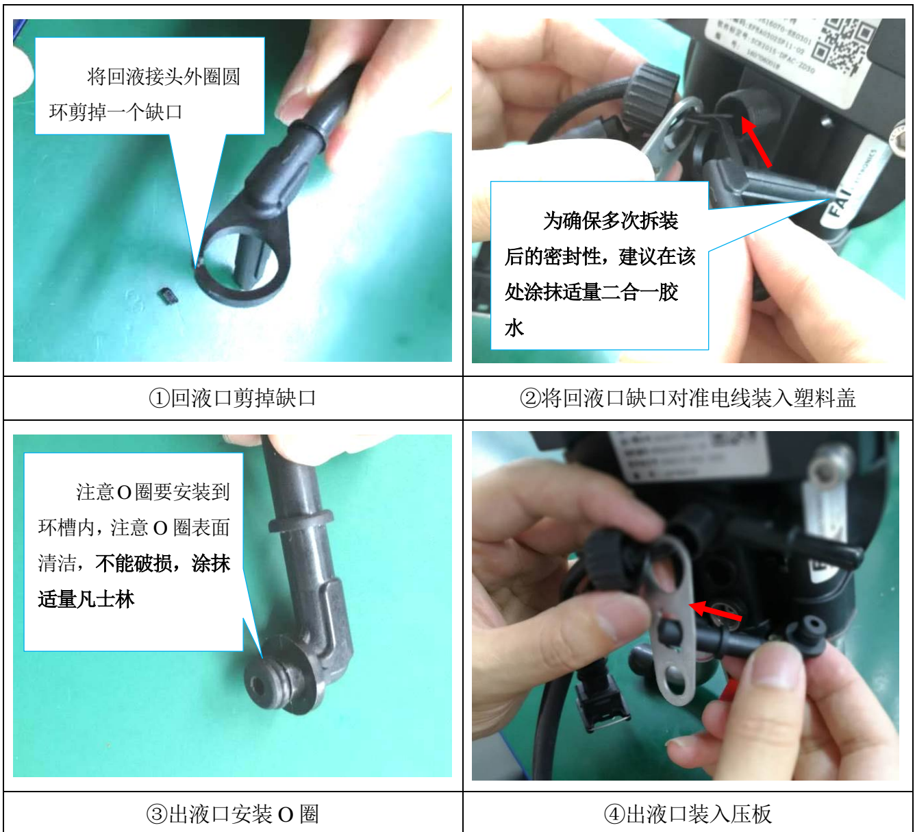
图 5-5 出回液接头拆卸方法
