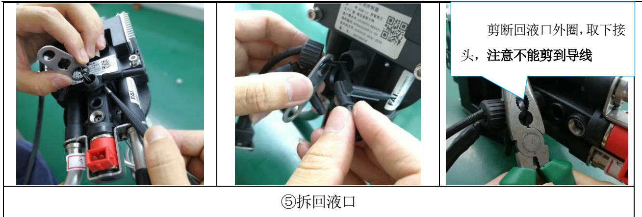
图 5-5 出回液接头拆卸方法
