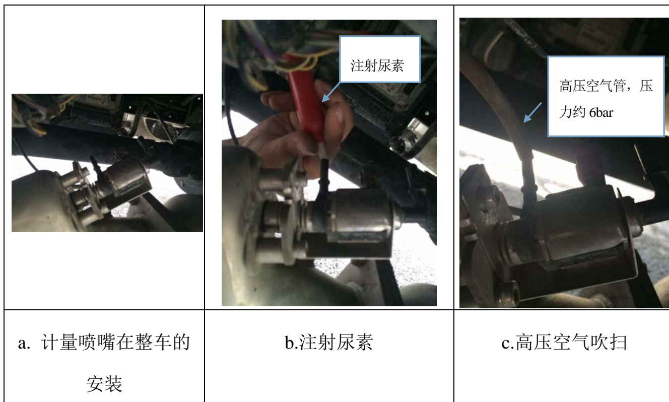
图 5-3 计量喷嘴反向清扫服务方式图解
