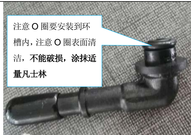
图 5-6 出液口拆卸方法
