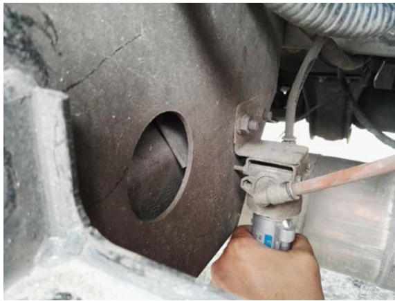
1) 逆时针旋转拆掉空滤水杯
