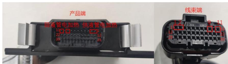
图 3-46 国六 DCU 中电加热相关引脚图
