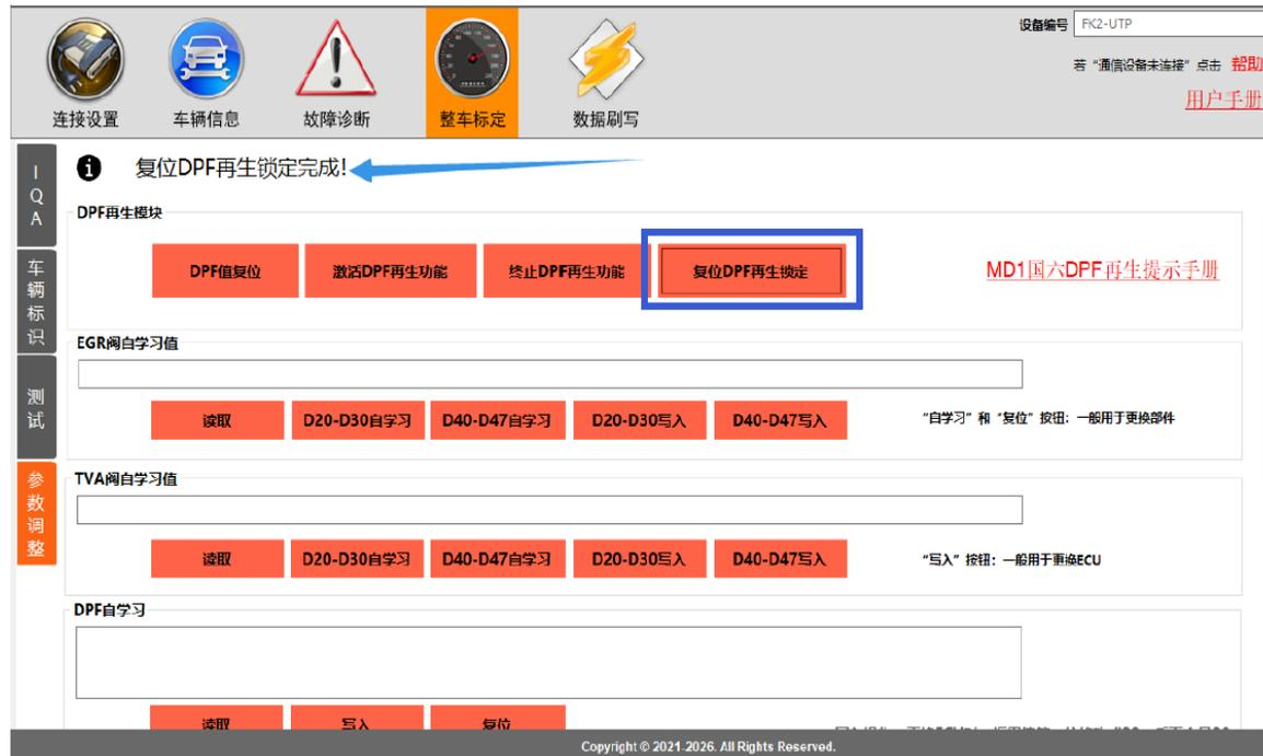
图 3-13 博世燃油系统“复位 DPF 再生锁定”
