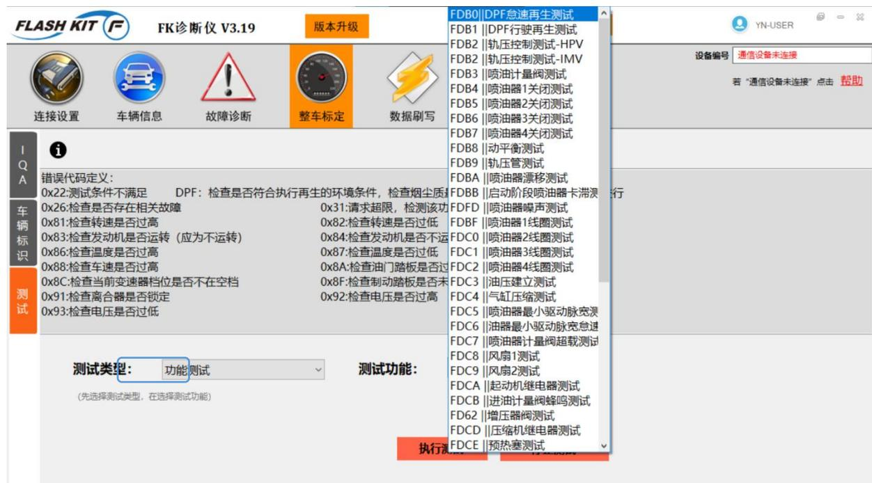
图 3-17 德尔福燃油系统“怠速再生测试”
