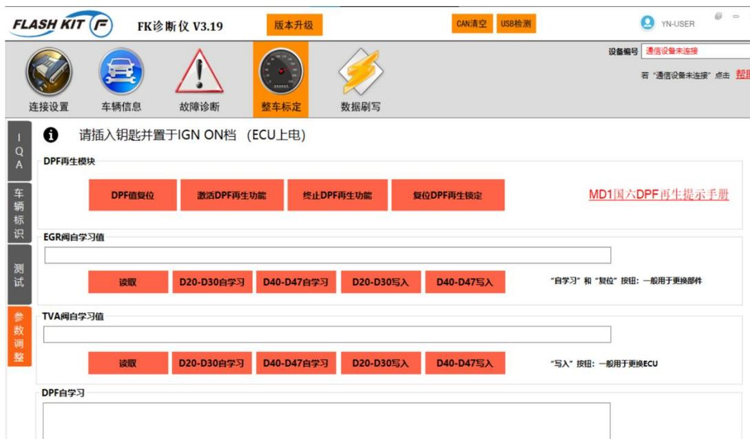
图 3-11 博世燃油系统诊断仪再生操作界面
