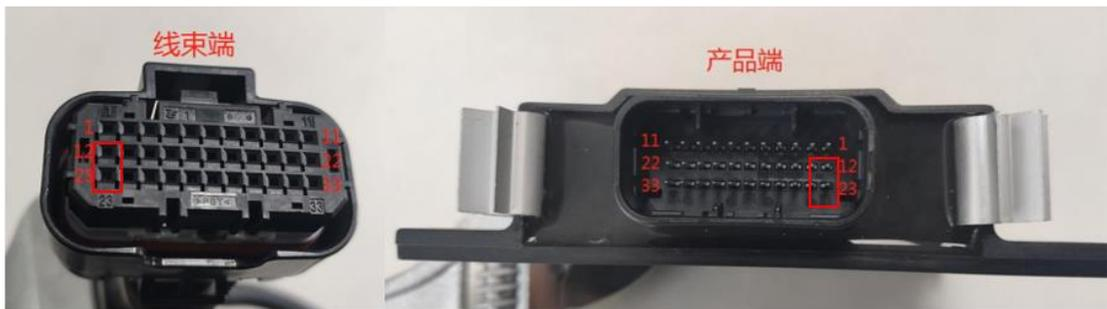
图 3-31 DCU 接插件
