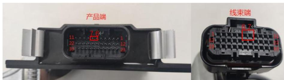
图 3-41 国六 DCU 中断水电磁阀相关针脚图
