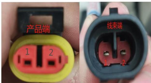
图 3-45 尿管电加热线束端与产品端
