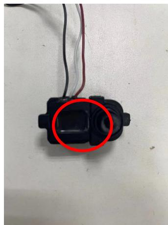
图 3-52 压力传感器线束端
