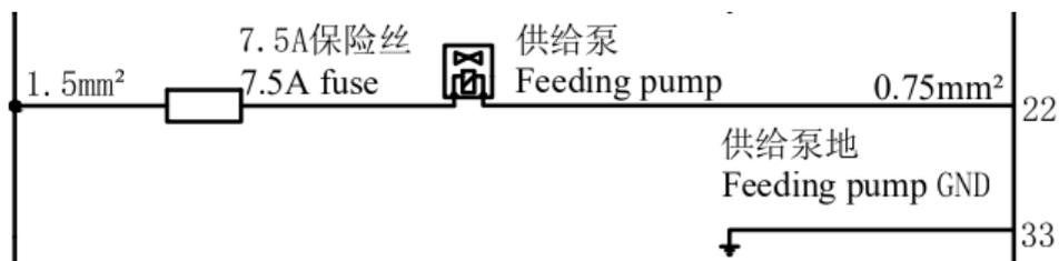
图 3-24 供给泵电气原理图
