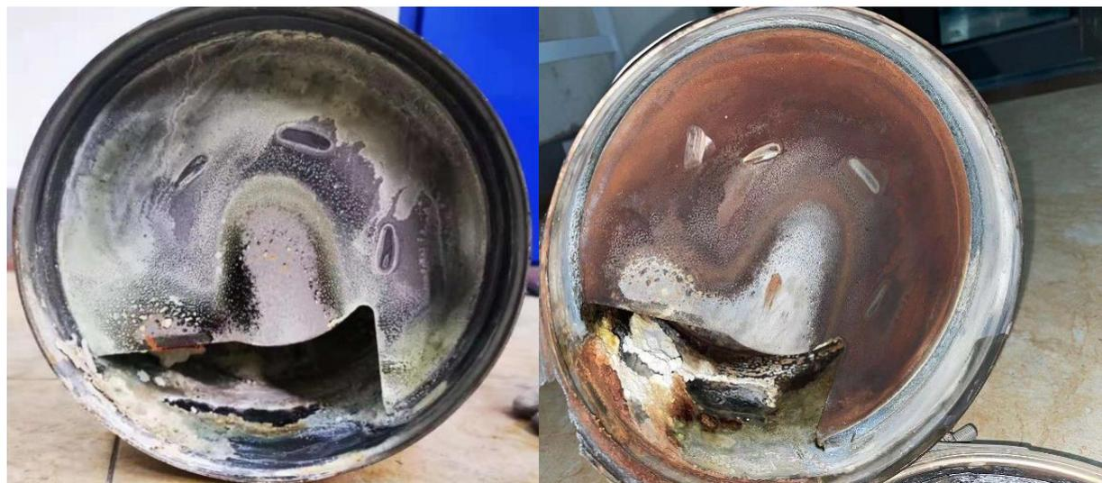
图 3-8 高含硫燃油致严重结晶
