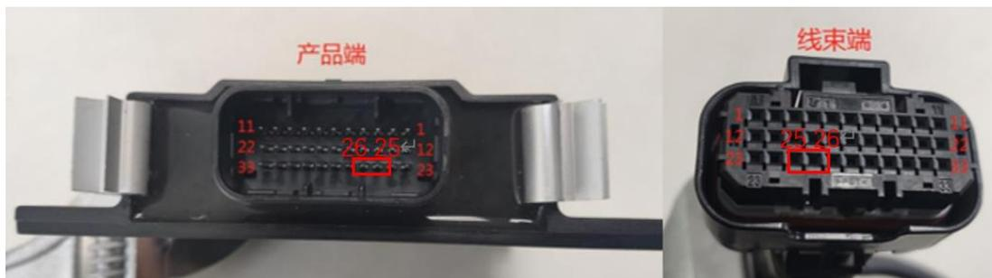
图 3-61 国六 DCU 中 CAN 通讯相关针脚图
