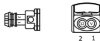
图 3-29 喷嘴接插件针脚示意图
