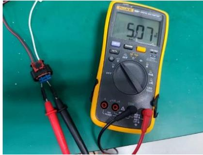
图 3-66 压差传感器线束端 1 号针脚和 2 号针脚之间的 5V 电压
