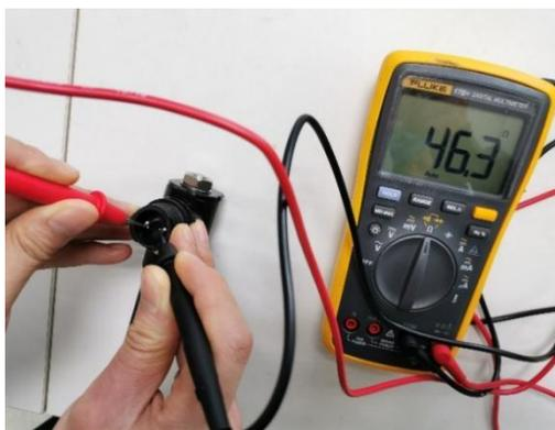
图 3-42 测试断水电磁阀产品端接插件两针脚间电阻
