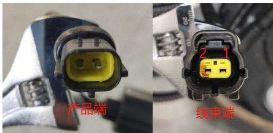
图 3-36 吹扫泵产品端和线束端
