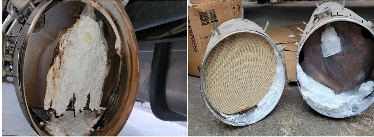
图 3-5 SCR 严重结晶
