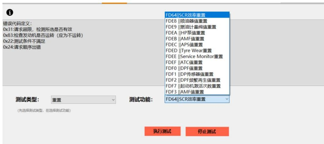
图 3-20 德尔福燃油系统再生后 SCR 效率重置
