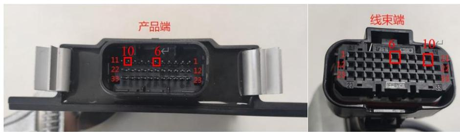
图 3-37 国六 DCU 中吹扫泵相关针脚图
