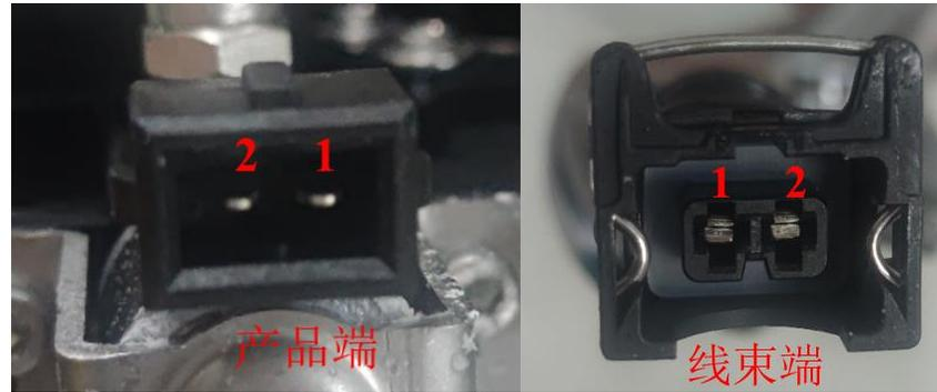
图 3-50 空气电磁阀产品端和线束端
