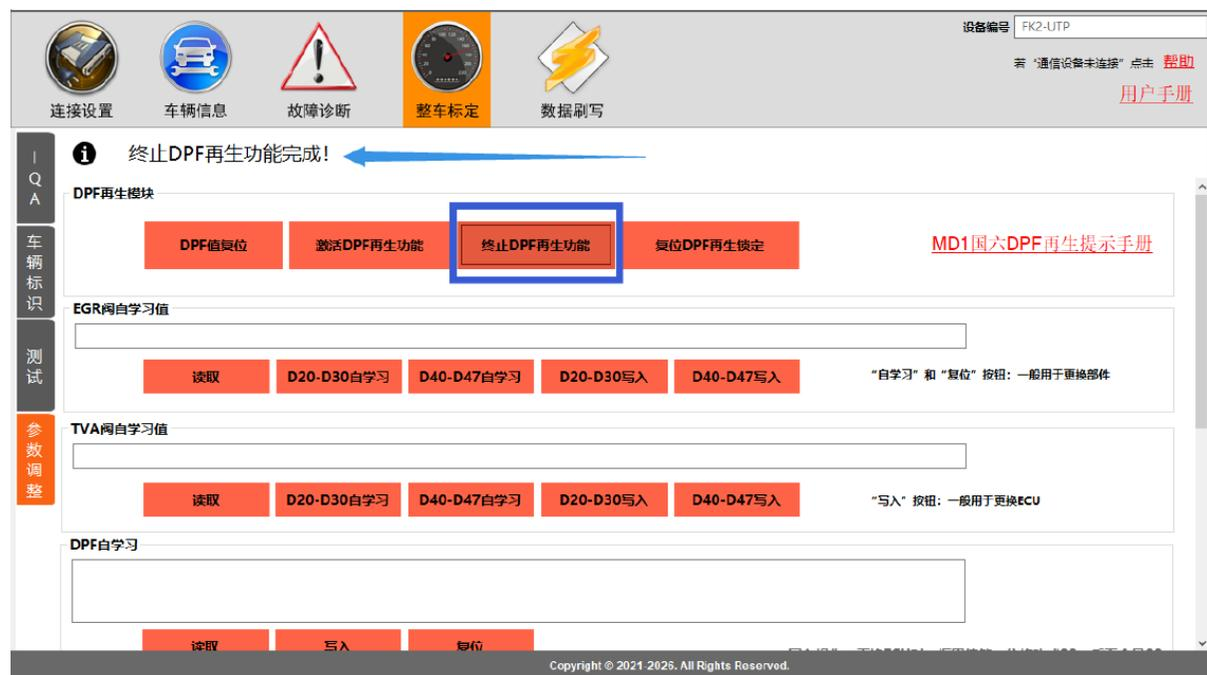
图 3-15 博世燃油系统“终止 DPF 再生功能”
