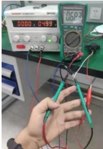
图 3-67 压差传感器 1、2 号针脚供电后 2、3 号针脚之间的电压
