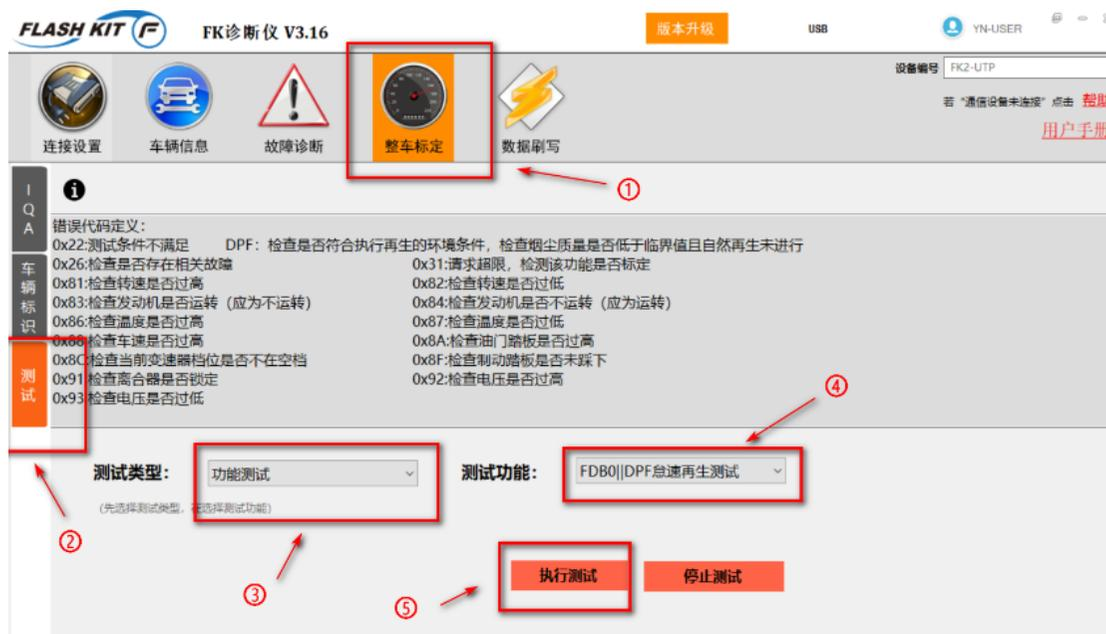
图 3-9 德尔福燃油系统诊断仪再生操作顺序
